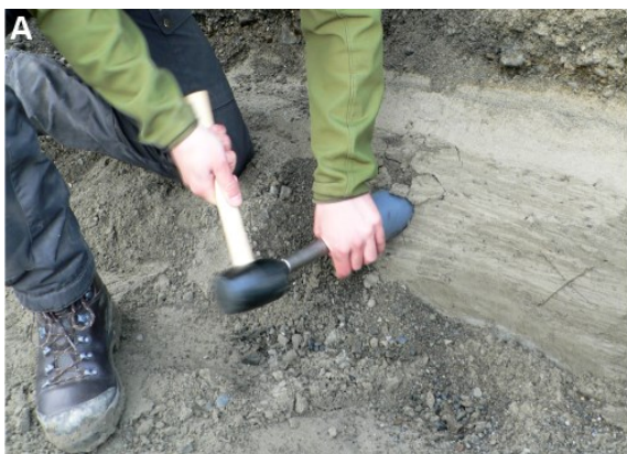
Figur 17 A, B. All provtagning och analys för luminiscensdatering måste utföras utan att provet utsätts för ljus och därmed nollställs och ger felaktigt resultat. Prover tas därför i ljusstäta stål- eller PVC-rör som hamras in i sedimenten (A), eller nattetid, och i luminiscenslaboratorier används svag röd eller orange belysning (B). Foto: Helena Alexanderson.
