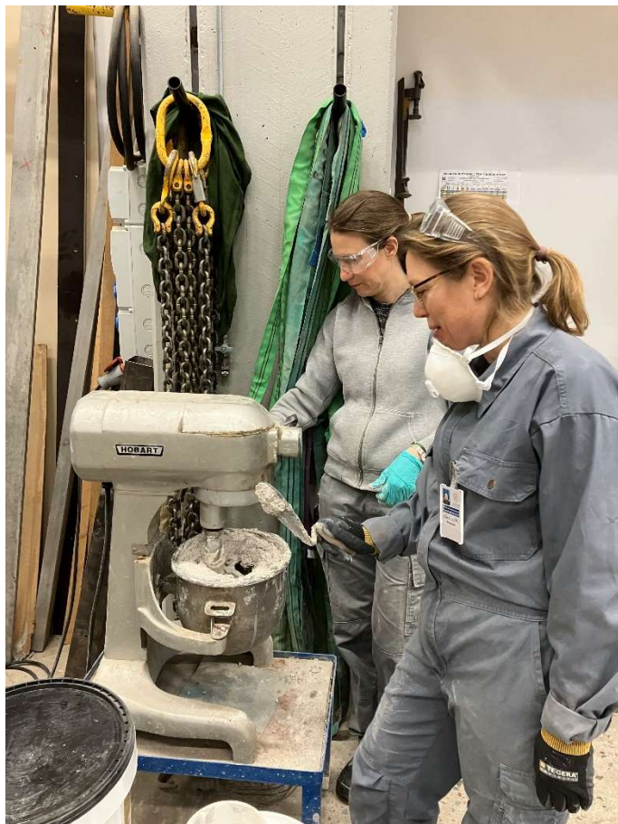
Figur 5.2 Fogbruk blandas med Hobart mixer, t.v. Paulien Strandberg, t.h. Malin Ek.
