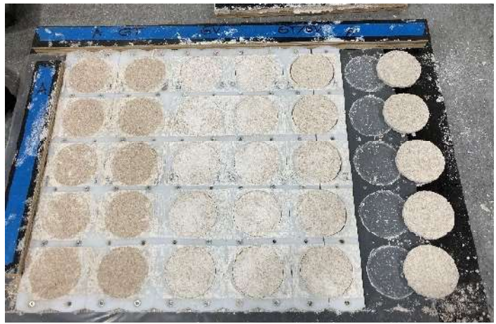
Figur 5.5 Cylindrar av kalkbruk i formar.
