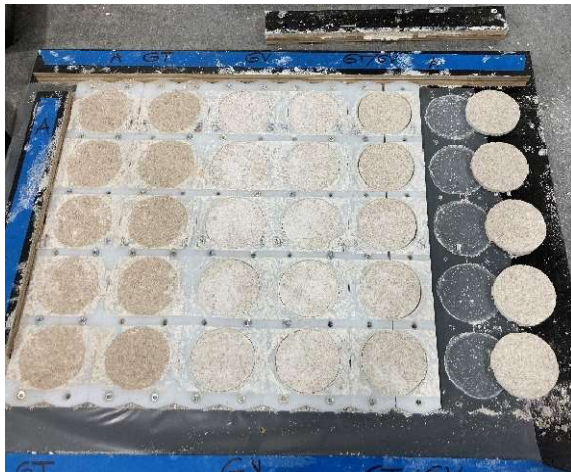
Figur 5.10 Mall med provkroppar för koppförsök.
