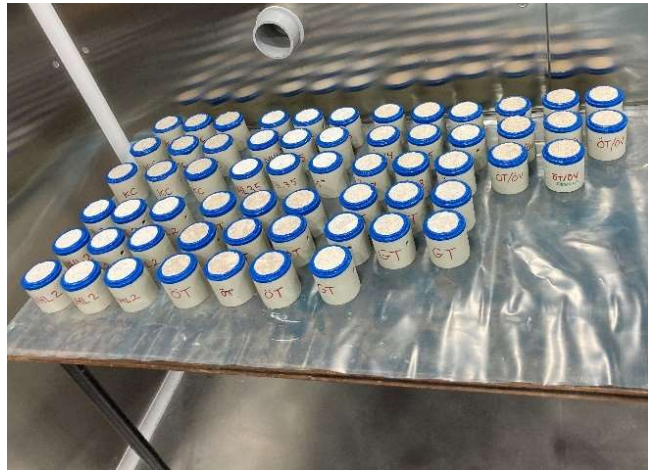
Figur 5.11 Koppar placerade i klimatrum.
