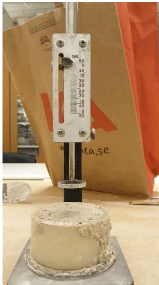
Figur 5.3 Vicat-kolv för mätning av brukets konsistens. Foto: Malin Ek.
