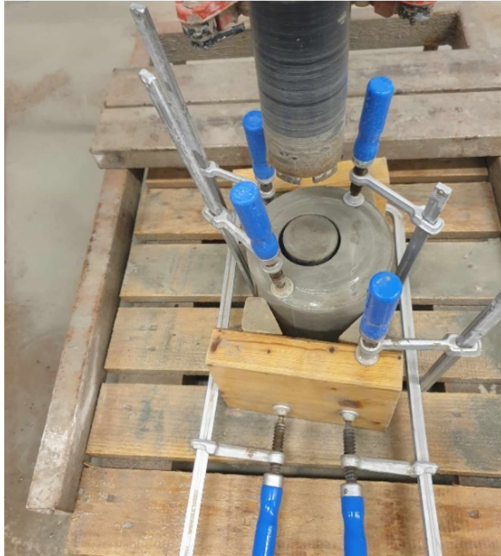
Fig. 2.2.1 Utbörning av betongcylindrar, ur betong gjuten i plåtburkar.
