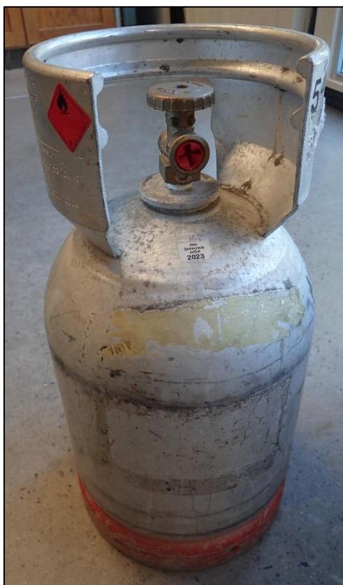
Figur 9: Flaska av aluminium med säkerhetsventil och smältsäkring.
