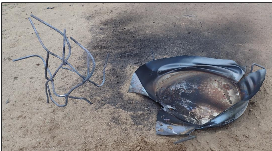
Figur 16: Ställning och plåtfat efter explosion av aluminiumflaska.
