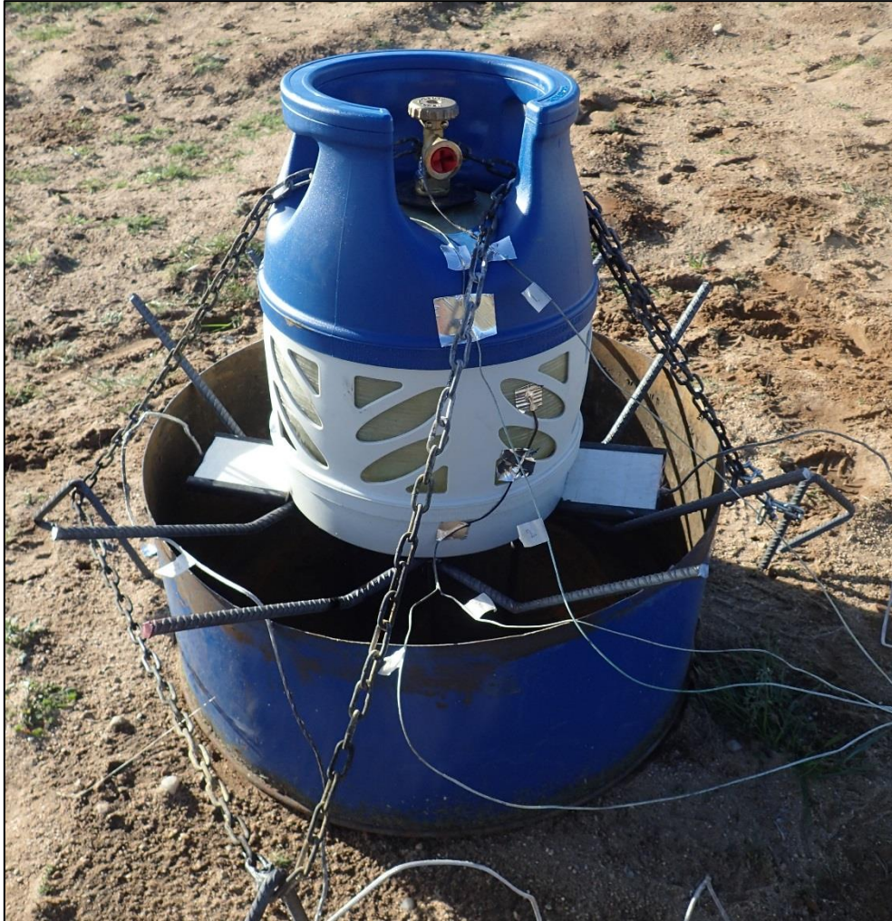
Figur 4: Försöksupställning med fat, termoelement, plattermoelement, flaska samt förankring (kätting och jordspett). Utloppsventil vinklades i respektive försök för bästa visuella resultat.
