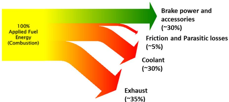
En typisk energikaskad för en förbränningsmotor.
