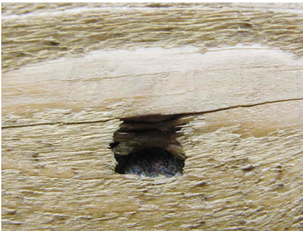
Figur 39 Mycket djupt spikhål intill en spricka som förstorat skadan i virket.
