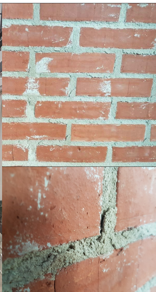
Bild 24. Tryckta sidan av testväggen - vid höga lastnivåer krossas och lossnar det svaga murbruket (M0.5) i fogarna.
