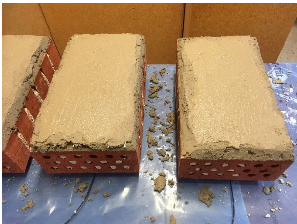
Bild 15. Provkroppar för utvärdering av putsens krympeffekter – provkroppen till vänster med armering, den till höger utan armering.
