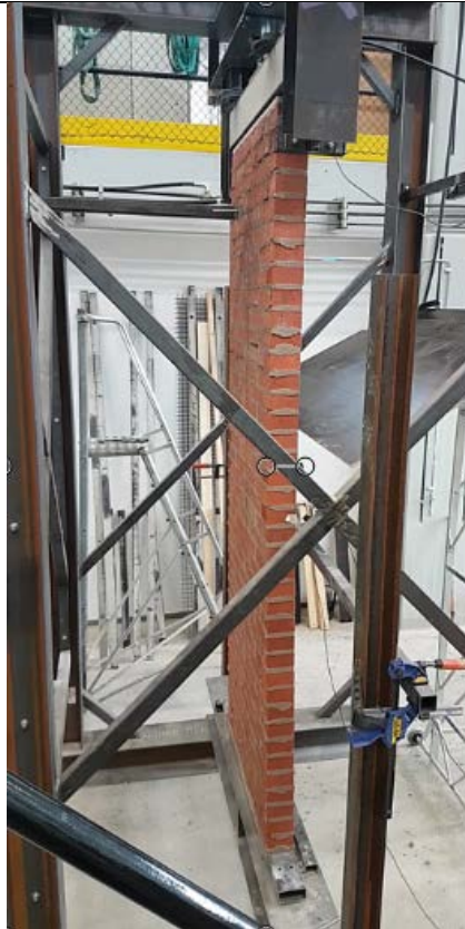
Bild 15. Testväggen strax innan brottet sker.
