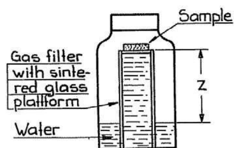
FIG 5 Suction apparatus. Range pF0-pF 1 à 2. /9/.
