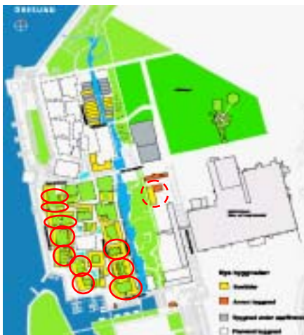
Bild 2:1 Inringade fastigheter på karta över Bo01-området är med i studien. Streckad ring visar var Sydkrafts värmecentral ligger, där mätare av utetemperatur sitter. Källa: karta från LIP-kansliet.
