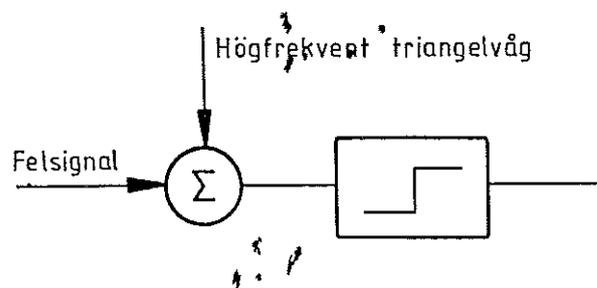
Fig. 4.15 - Linjärisering av reläkaraktistik genom högfrekvent tillsatssignal.
