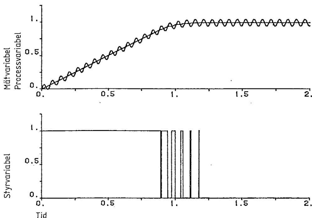
Fig. 4.14 - Stegsvår vid trelägesreglering av integrator med mätfel.
