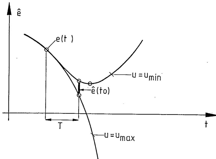
Fig. 4.8 - Prediktion av reglerfelet för dubbelintegratorn.
