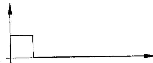
Fig. 4.7 - Stegsvär för till-från reglering med prediktion (4.5)(4.6) med  $T_D = T$  för en process som beskrivs av (4.3).
