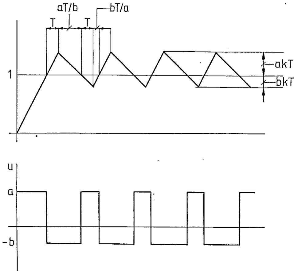
Fig. 4.4 - Stegsvår för en enkel krets med till-från reglering ( $u_{\min} = -b$ ,  $u_{\max} = a$ ,  $a, b > 0$ ) av en process som beskrivs av (4.3), dvs. en integrator med tidsfördröjning.
