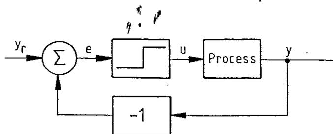
Fig. 4.2 - Blockschema för process med till-från reglering.
