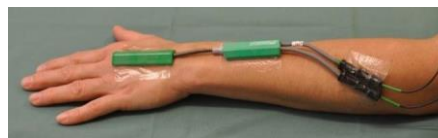
Figur 2. Goniometer som mäter positioner och rörelsehastigheter i handlederna.
