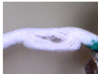
Figur: Simulering (a) och mikroskop (b) bilder av vikning av en bigad kartong. Färgkonturen i simuleringen indikerar hur skadat materialet är.
