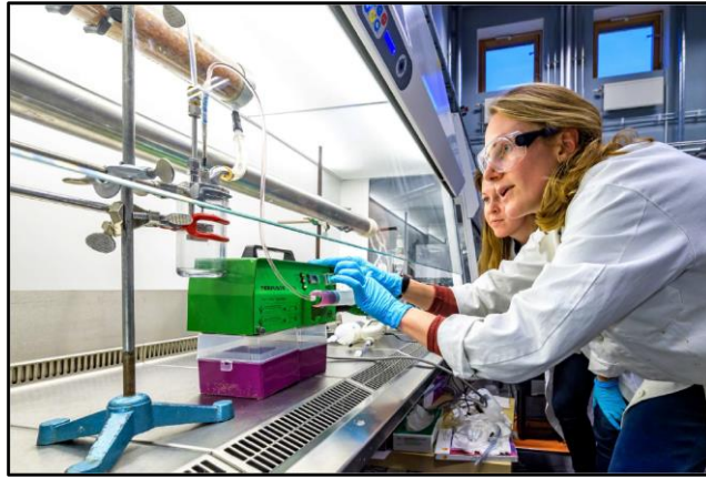
Experimentuppställning för aerosolisering av virus och bakterier i laboratorium. Foto: Kennet Ruona.
