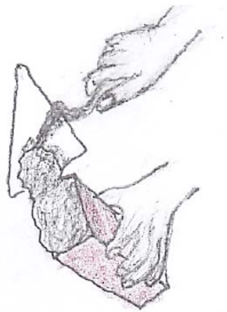
Figur 11.20. Bruk ska läggas på hela kopytan, inte bara på delen närmast utsidan, för att minimera risken för regngenomslag.
