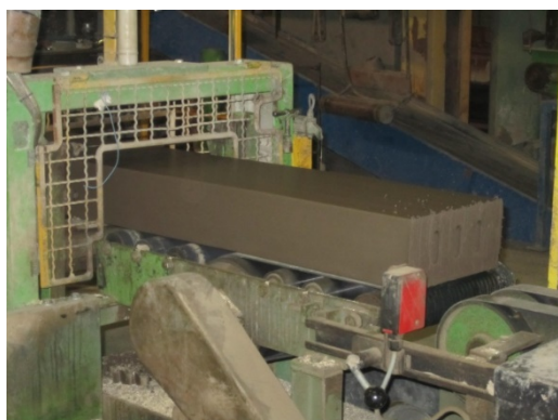
Bild 2.3, t.v. och 2.4, t.h., strängpressning, lersträngen trycks ut ur ett munstycke, t.h. skärs teglet av vid avskärningsbordet.
