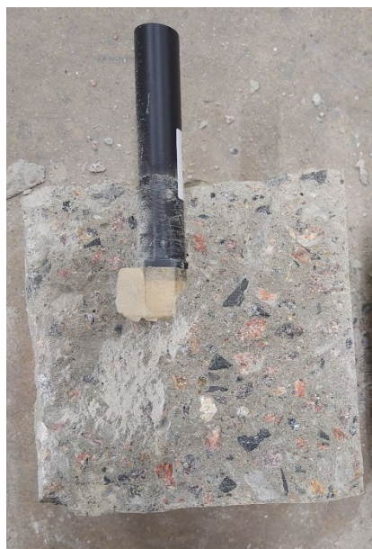
Figur 3.7 Halverad betongkub med fuktsensor från Electrotech.
