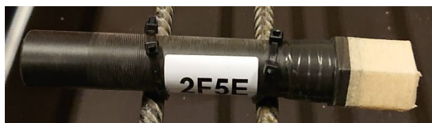
Figur 3.2 Electrotechs fuktsensor med plasthuv och microporetejp lindad kring plasthuv
